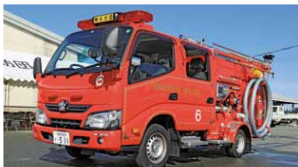
▲従来と変わらない放水性能を持つ普通免許対応の消防車
