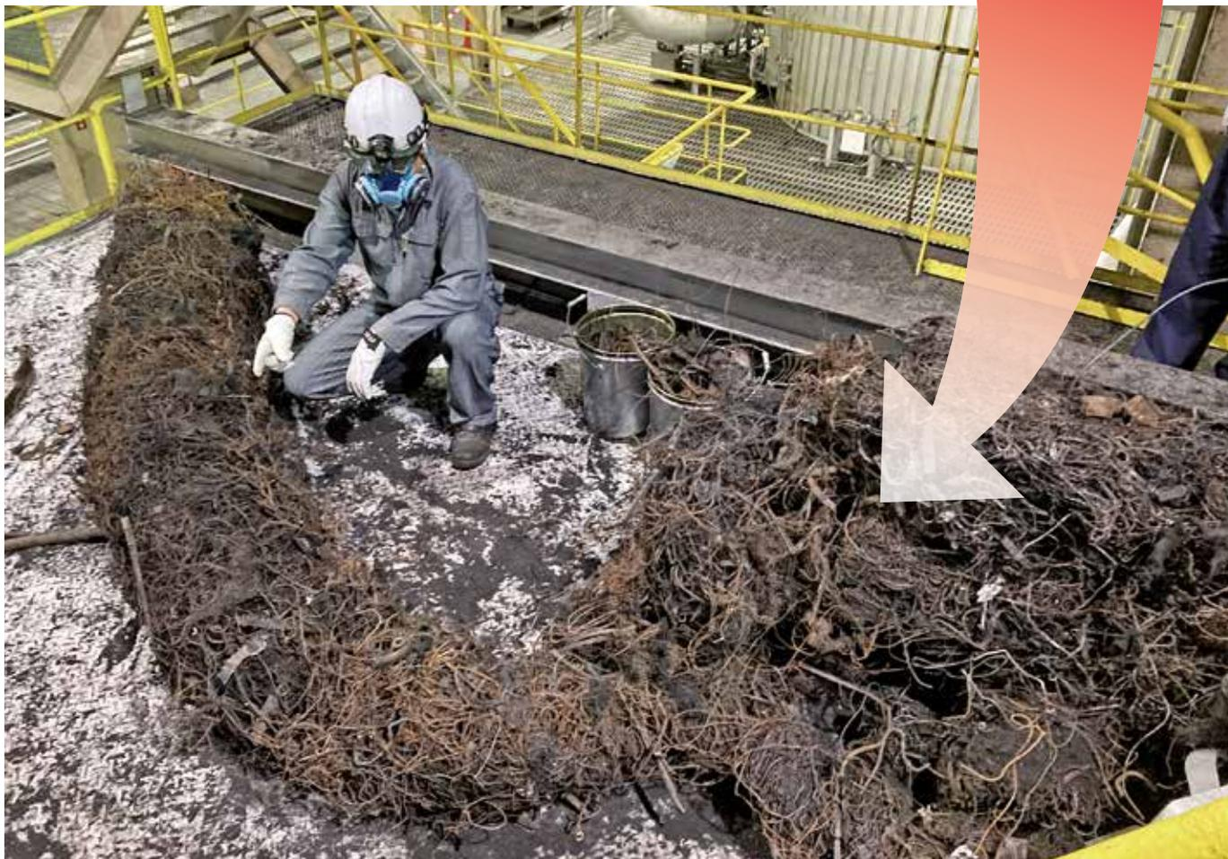
▲ゴミ袋の中に混入した金属が、焼却炉内で直径40cm・長さ13mの塊になったもの
