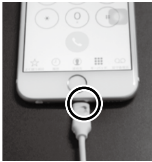
▲発熱し焦げた充電ケーブルの接続部分
