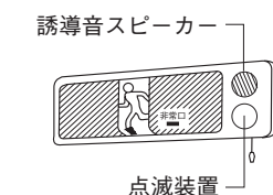
誘導音付点滅型誘導灯
