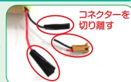
コネクターを切り離しリード線の先端を絶縁／リード線は短絡防止のため1本ずつ切断
