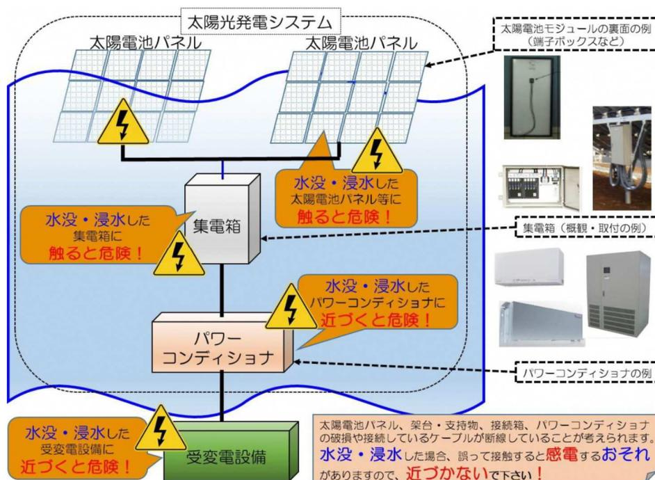
資料出所：「太陽光発電設備の水害時の感電の危険性について」
