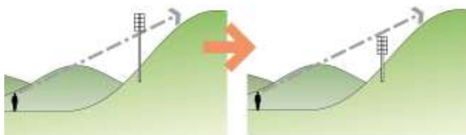
▲稜線を阻害しないように高さを抑えた例
