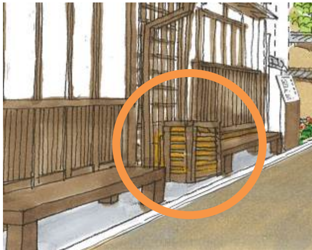
▲周辺との調和に配慮し、修景を施した設備の例
