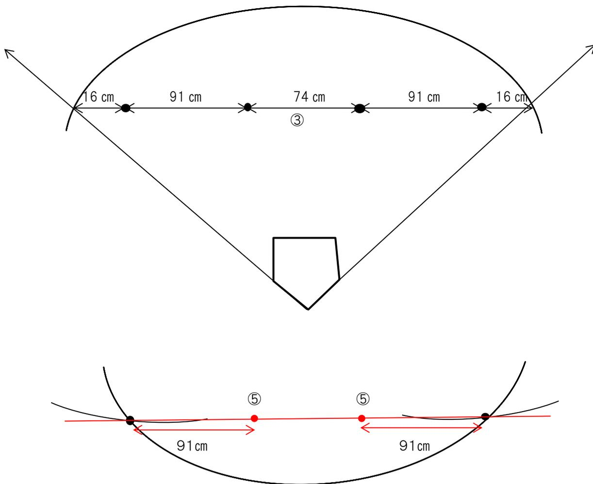
⑥ ④でとった点の延長上に 3.05m の点を打ち、下図のとおり各点を結ぶと完成となる。
