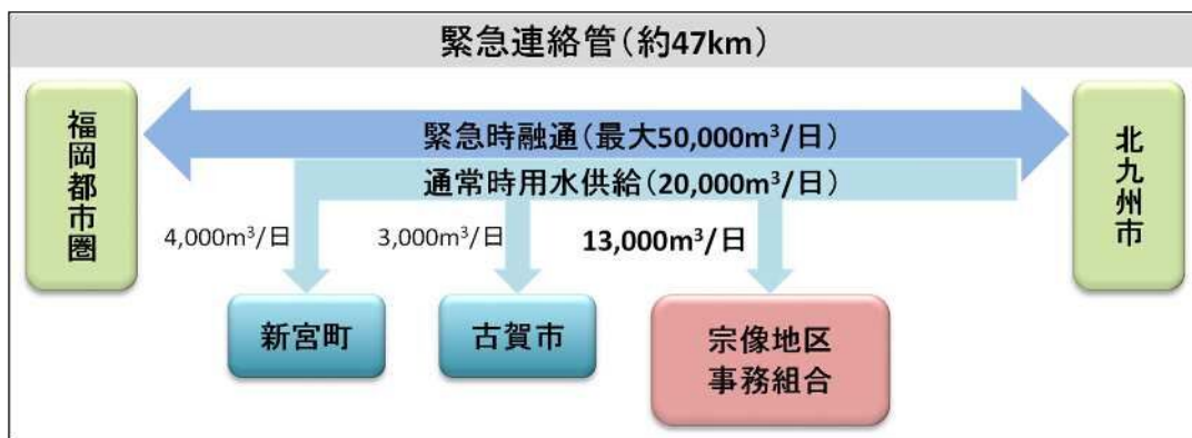
図 3-2 北部福岡緊急連絡管の水の流れ
